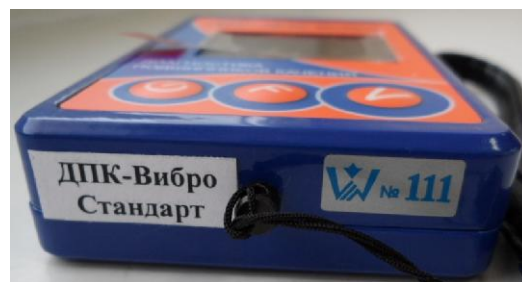
Рисунок 2 - Внешний вид виброметра серии «ДПК-Вибро» (вид сверху)
