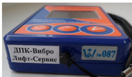
Рисунок 2 - Внешний вид виброметра серии «ДПК-Вибро» (вид сверху)
